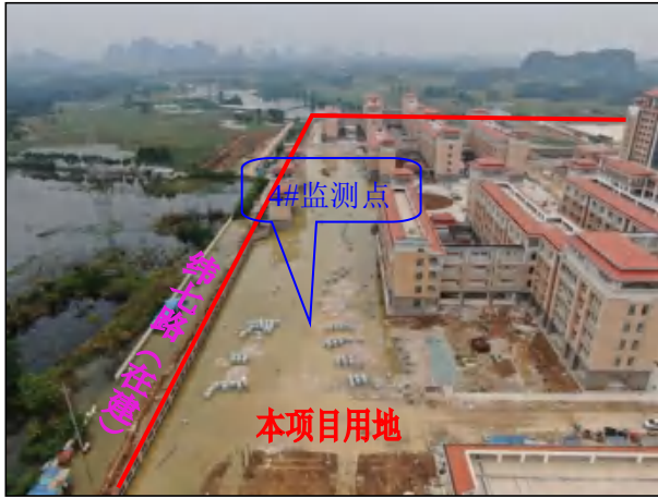
项目用地南面校园大门处，因校园外无市政排水，雨水无法外排，用地被雨水浸泡
