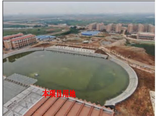
项目用地西北面、北面用地现状，足球场用地，因雨水无法外排，用地被雨水浸泡
