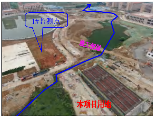
项目建设时在中部、北面跨大冲塘处设置2条施工便道，桥梁建成后，本项目拟对其进行拆除
