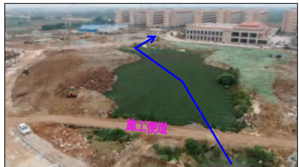
穿过本项目用地内的大冲塘河段中部现状，施工在该区设置 1 条施工便道，后期拆除交还河道用地
